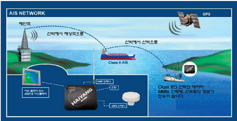
<선박간의 AIS송수신은 다음 그림과 같은 방식으로 작동이 됩니다>
